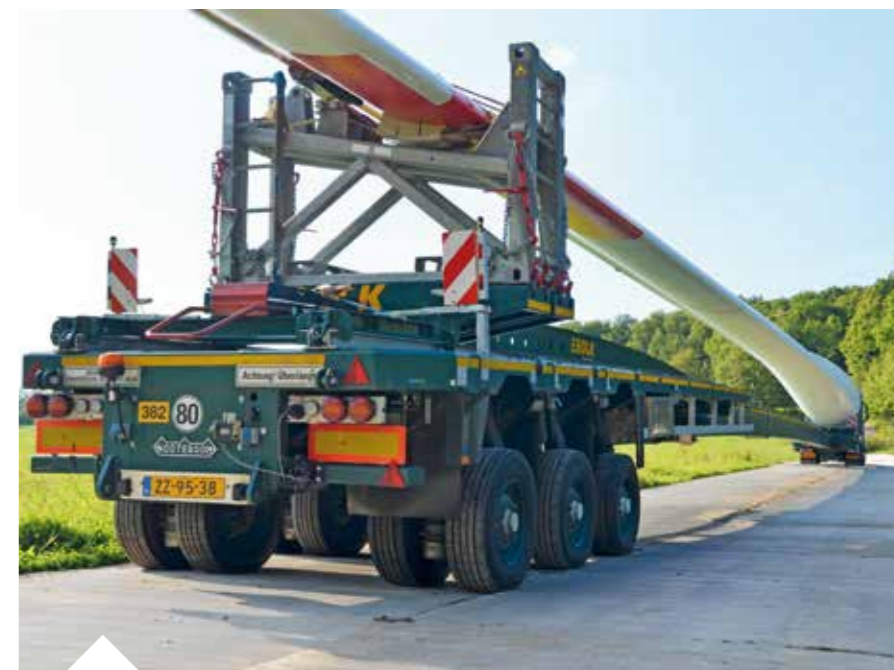
■ El Super Wing Carrier (SWC) puede entregar las palas en lugares de difícil acceso
