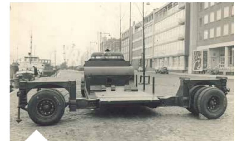
■ Ejes oscilantes abiertos: los primeros ejes pendulares de los cincuenta
