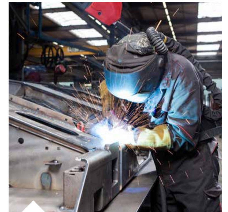
■ La soldadura de pulso reduce el tiempo dedicado a la limpieza posterior
