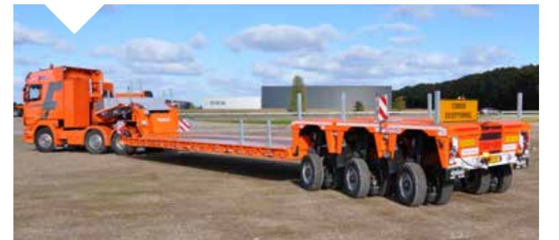
■ La altura de suelo del PX-2 se ha reducido en 10 centímetros usando neumáticos 245
